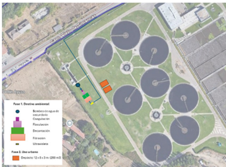
Figura 15 Ubicación depósitos de almacenamiento.
